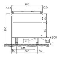
Electrical inlet (power) Equipotential screw
